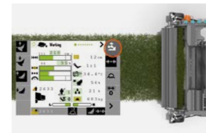
Alimentarea hidraulică PFS poate fi reglată în mod confortabil din scaunul tractorului.
